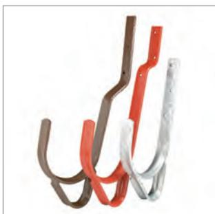
Le modèle pour les tuiles béton et terre cuite est cambré de 45 mm, celui pour les tuiles plates écailles de 32 mm. Cela permet une pose facile avec des hauteurs de latte de 24 à 32 mm.
